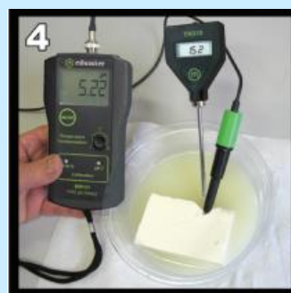
ИЗМЕРВАНЕ на рН в МЛЕЧНИ ПРОДУКТИ
