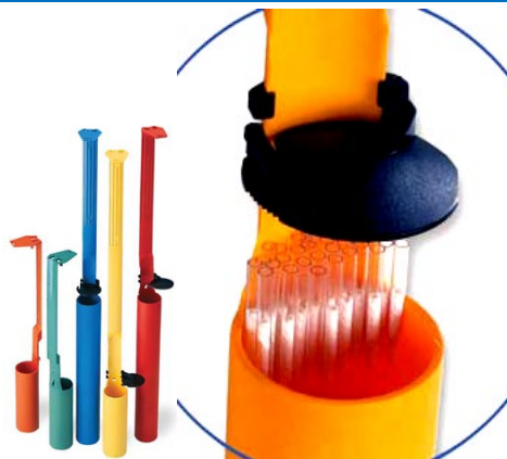
Система против изплуване на сламките, съхранявани в пластмасовите кутии
