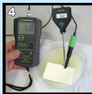
ИЗМЕРВАНЕ на pH в МЛЕЧНИ ПРОДУКТИ
